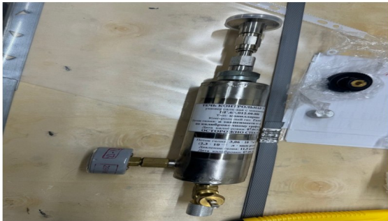
LeakLab — контрольная течь с манометром No045
