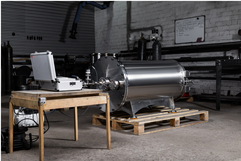
Камера на этапе первичного контроля с измерительной обвязкой.
