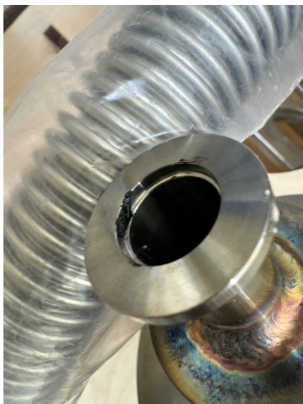
Рисунок 27 — Соединение гофрированного трубопровода с патрубком. Гофры, сужения и переходы учитывают при оценке проводимости измерительного тракта.
